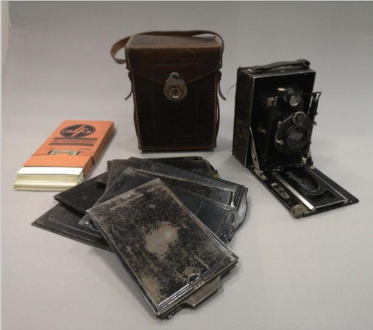
Aparat fotograficzny „Avus” Voigtländera z obiektywem Anastigmat Skopar (1:4,5) na szklane płyty 9x12 i metalowe kasety firm Voigtländer, Agfa, Leningrad.
