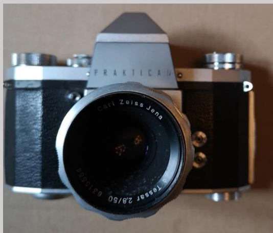
Małoobrazkowa lustrzanka jednoobiektywowa „Praktica IV” (NRD, firma Carl Zeiss w Jenie) z obiektywem Tessar 1:2,8/50 mm
